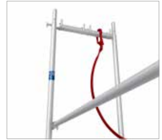
Bild 96: Anschlag am oberen Querriegel des Vertikalrahmens
