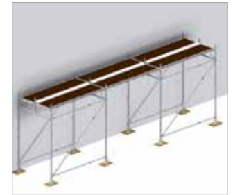
Bild 78: Gerüstabschnitt mit Durchgangsrahmen und auf voller Breite eingebauten Belagelementen
