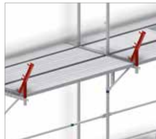
Bild 66: Montage der Schutzdachaufsätze
