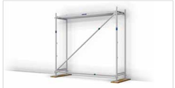
Bild 25: Fertig montiertes, erstes Gerüstfeld
