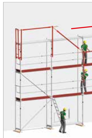
Bild 37: Hochsetzen des Montagesicherheitsgeländers (MSG)
