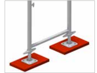
Bild 5: Lastverteilernder Unterbau mit Bohlenstücken unter jeder Fußplatte
