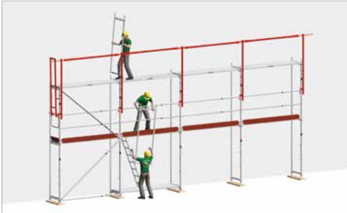
Bild 34: Montage der weiteren Gerüstlagen im Schutze des MSG
