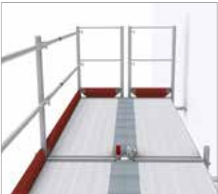
Bild 61: Oberste Gerüstlage mit Außenkonsole 0,65 m und Spaltabdeckung zwischen Haupt- und Konsolbelag
