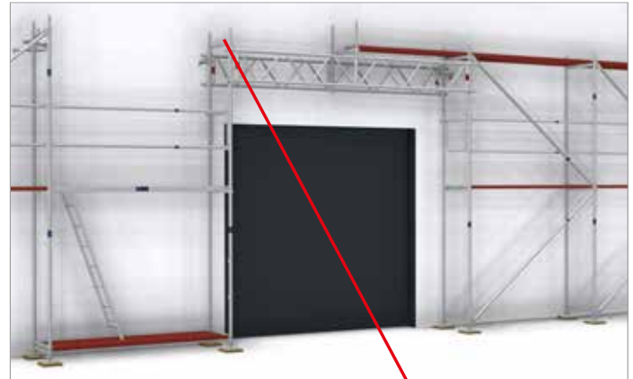
Bild 81: Montage eines Gerüstabschnittes mit Gitterträgerüberbrückung
