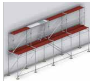
Bild 79: Gerüstabschnitt mit Durchgangsrahmen und Verstrebungen sowie Verankerungen in Höhe H = 4,0 m, Montage der zweiten Lage
