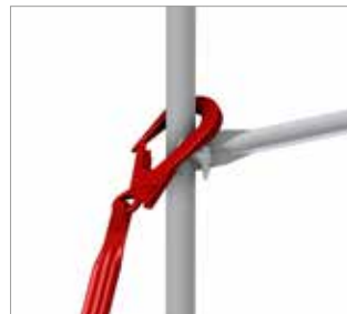
Bild 97: Anschluss am Ständer oberhalb des oberen Geländerholms
