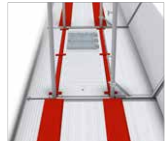
Bild 70: Spaltabdeckung zwischen Haupt- und Schutzdachbelag sowie zwischen Haupt- und Konsolenbelag
