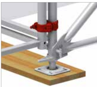
Bild 28: Anschluss der Vertikalrahmen im Fußbereich (Detail)
