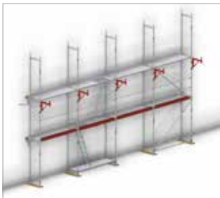
Bild 63: Konsole 0,65 m an der Außenseite des Gerüsts
