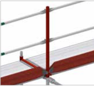
Bild 50: Oberer Abschluss des Gerüsts mit L-förmigem Geländerpfosten, Geländern und Bordbretter
