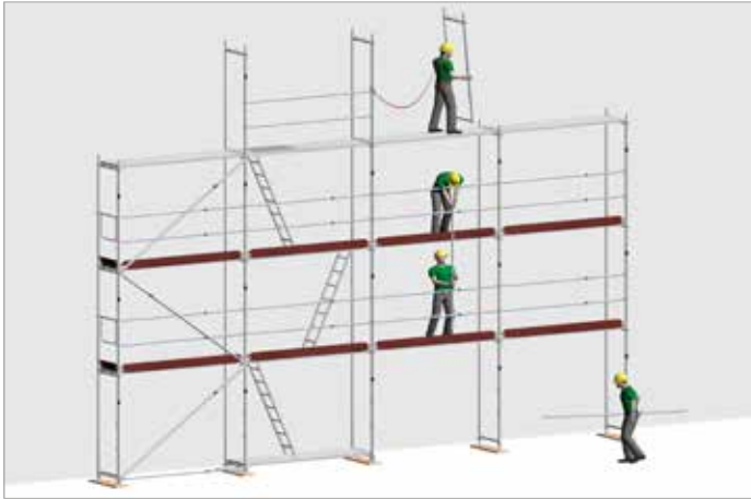
Bild 41: Montage eines Gerüstbereiches mit Hilfe der PSAgA
