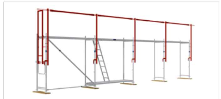
Bild 33: Erste Gerüstlage mit umlaufendem Montagesicherheitsgeländer (MSG)
