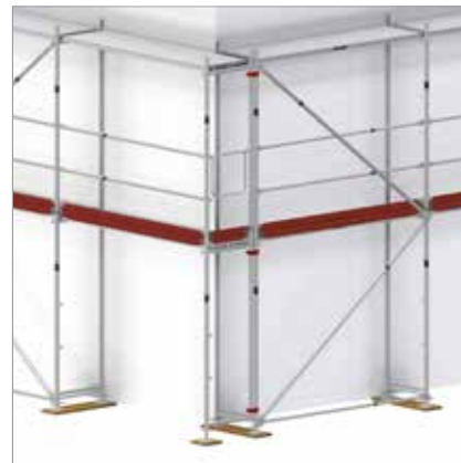
Bild 42: Eckausbildung in weiteren Gerüstlagen
