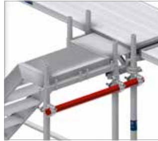
Bild 46: Verbindung zum Hauptgerüst durch Gerüstrohre und Kupplungen
