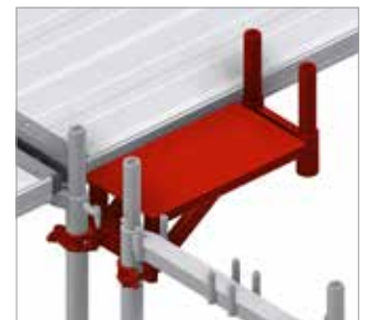
Bild 30: Treppenübergangskonsolle montiert zwischen Gerüstbelag und Vertikalrahmen des Treppenaufstiegs (Detail)
