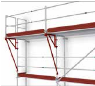
Bild 59: Gerüst mit außenliegenden Konsolen 0,65 m und Konsolstreben
