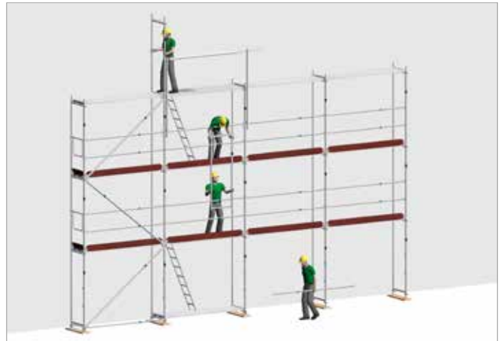
Bild 40: Montage des Aufstiegsfeldes im Schutze des MSG
