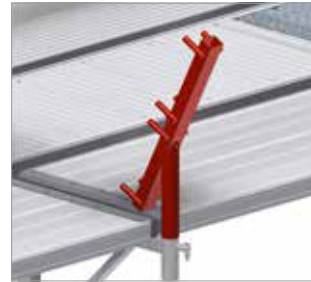
Bild 67: Montage der Schutzdachaufsätze (Detail)
