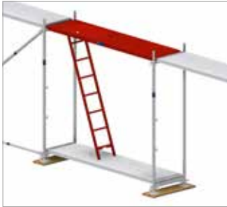
Bild 32: Innenliegender Leitergang, erste Gerüstlage
