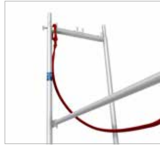
Bild 95: Anschlag am Ständer über dem oberen Querriegel
