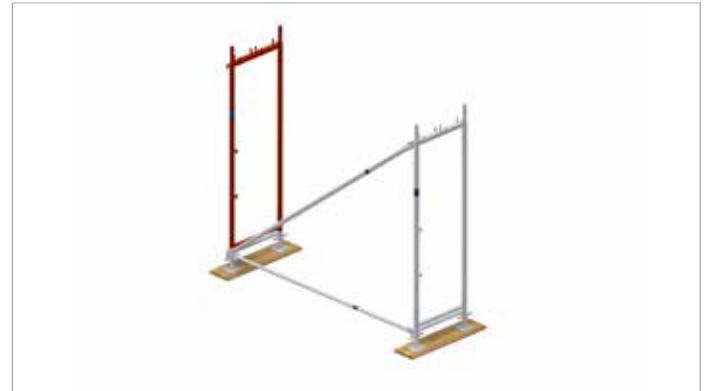
Bild 16: Aufbau des ersten Gerüstfeldes, zweiter Vertikalrahmen
