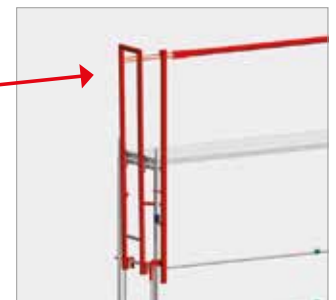
Bild 38: Hochsetzen des Montagesicherheitsgeländers (Detail)
