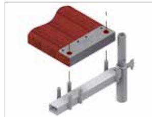
Bild 21: Aufschieben eines Systembelags auf die Einhängezapfen des Vertikalrahmens
