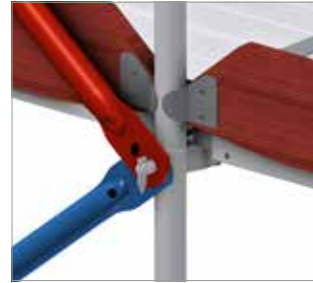
Bild 35: Anschluss des unteren Diagonalendes am Kippstift im äußeren Loch (ab der zweiten Gerüstlage)
