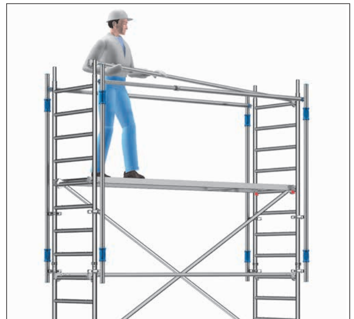
Bild 6: Sichere Montage der Rückenlehnen mit MSG
