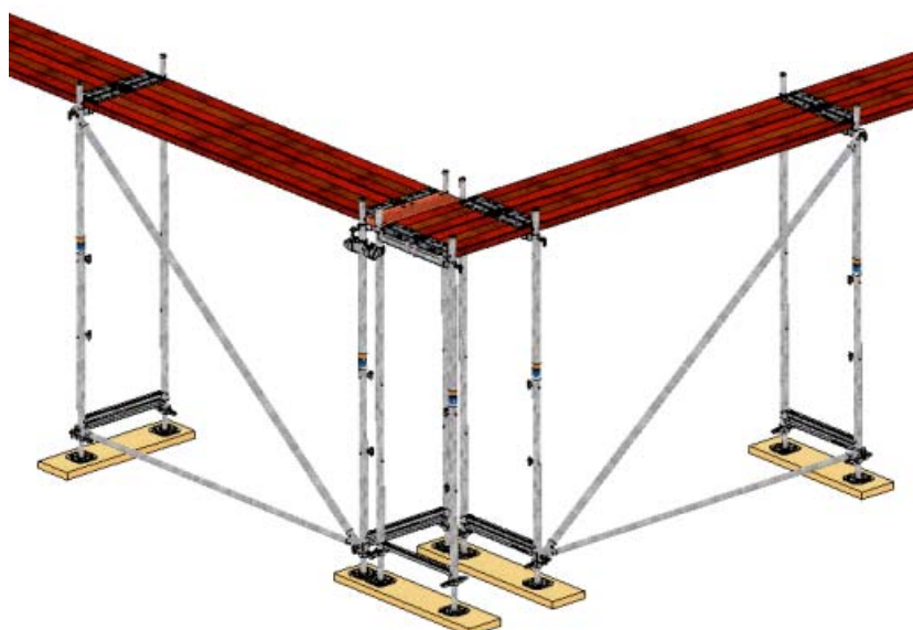
Bild 19: Eckausbildung mit drei Vertikalrahmen
