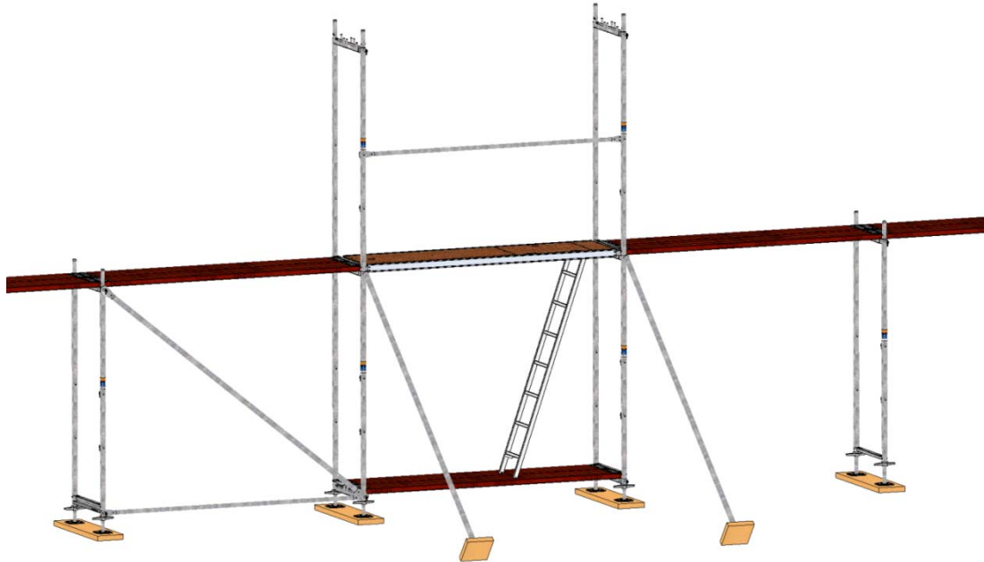
Bild 20: Beispiel für eine vorübergehende Kippsicherung der ersten Gerüstlage.
