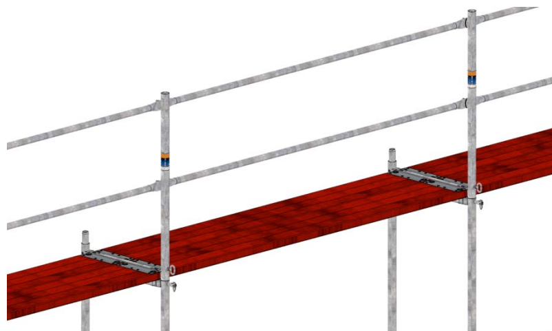
Bild 44: Oberer Abschluss mit Geländerpfosten mit Traversen.
