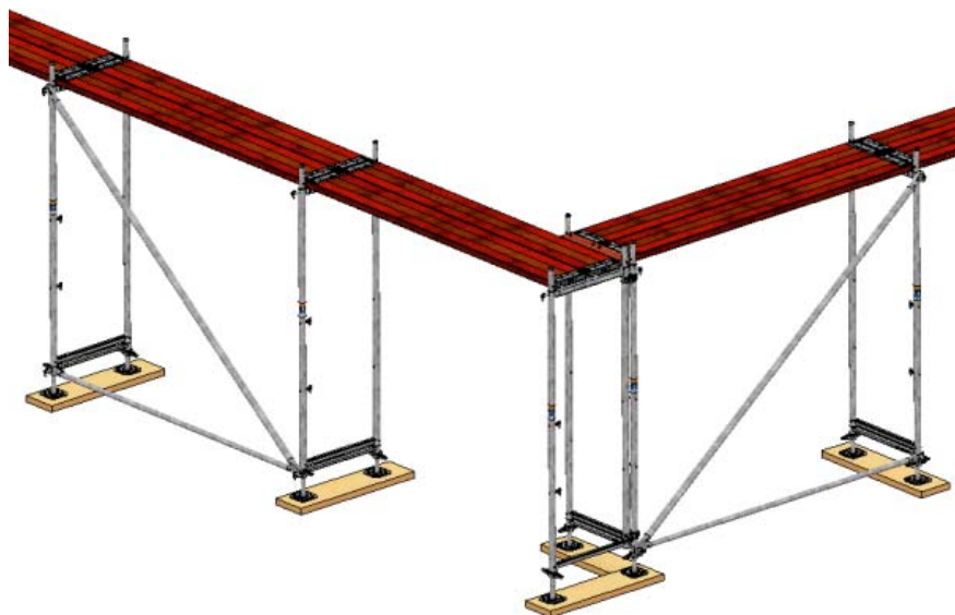
Bild 18: Eckausbildung mit zwei Vertikalrahmen
