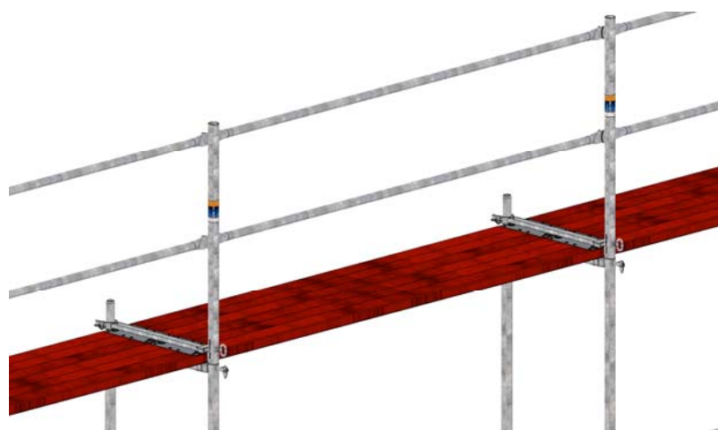
Bild 45: Oberer Abschluss mit Geländerpfosten und Belagsicherungen.
